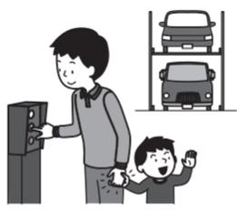
駐車装置の操作ボタンを器具などで固定し押し続けた状態にすることは絶対に行わないでください。
